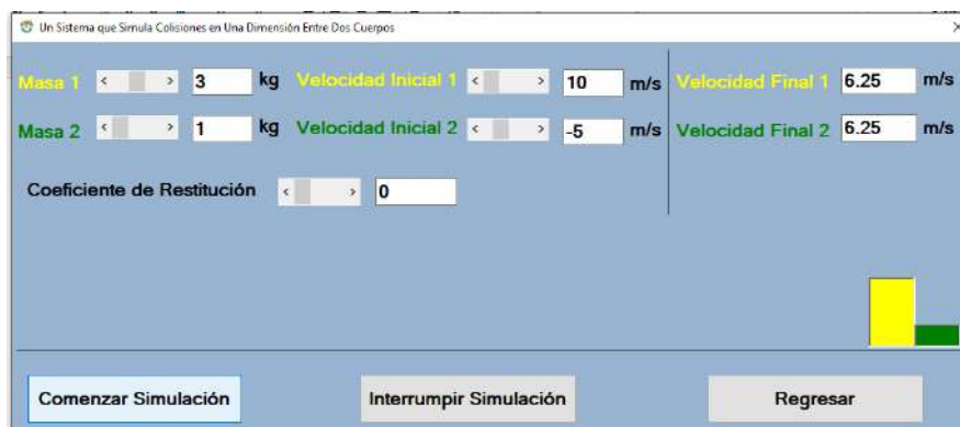
Figura 37. Ventana que muestra el resultado de la colisión cuando las masas de los cuerpos son diferentes, se mueven en direcciones contrarias con diferente velocidad y es una colisión inelástica.
