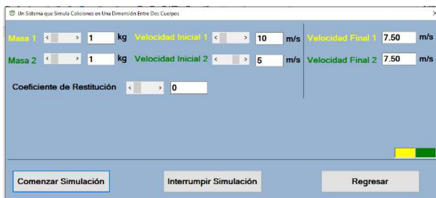
Figura 23. Ventana que muestra el resultado de la colisión cuando las masas son iguales, se mueven en la misma dirección con velocidades diferentes y es una colisión inelástica.
