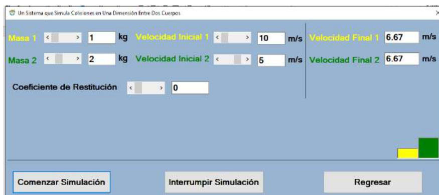
Figura 27. Ventana que muestra el resultado de la colisión cuando la masa que impacta es menor, se mueven en la misma dirección con velocidades diferentes y es una colisión inelástica.
