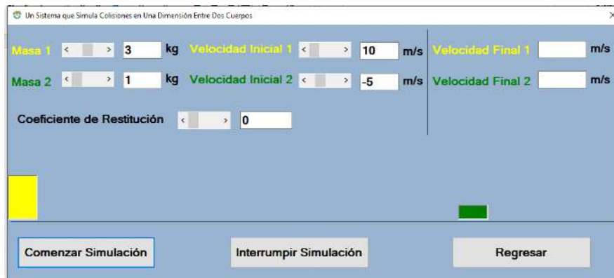
Figura 36. Ventana que muestra dos cuerpos con diferente masa que se mueven en direcciones contrarias, con diferente velocidad y coeficiente de restitución igual a cero.
