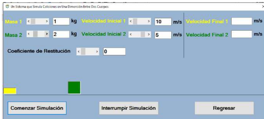
Figura 26. Ventana que muestra el cuerpo que impacta con menor masa, las velocidades en la misma dirección y coeficiente de restitución igual a cero.
