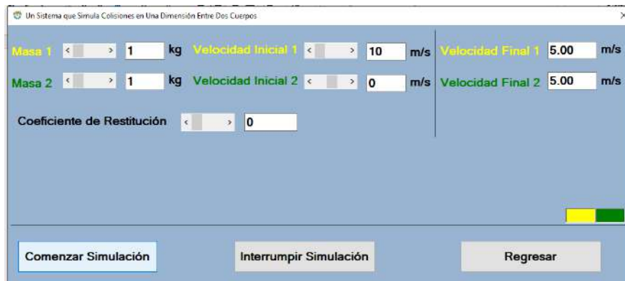
Figura 29. Ventana que muestra el resultado de la colisión cuando ambas masas son iguales, uno de los cuerpos está en reposo y es una colisión inelástica.
