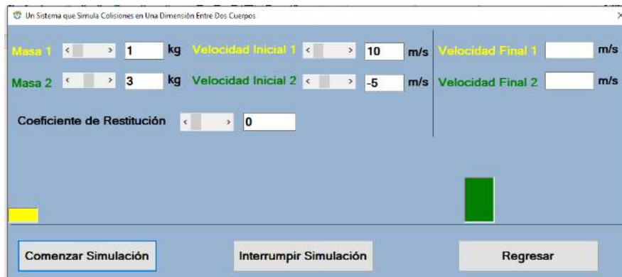
Figura 38. Ventana que muestra dos cuerpos con diferente masa que se mueven en direcciones contrarias, con diferente velocidad y coeficiente de restitución igual a cero.
