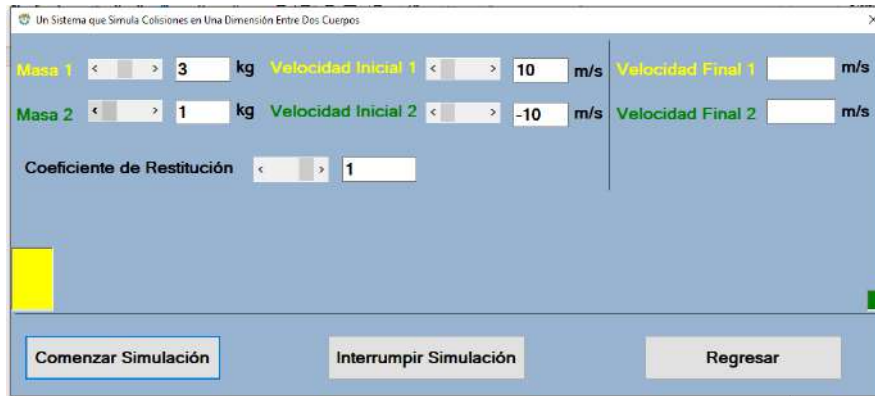
Figura 14. Ventana que muestra las velocidades de ambos cuerpos en direcciones opuestas y la masa de un cuerpo es tres veces mayor que la masa del otro cuerpo.
