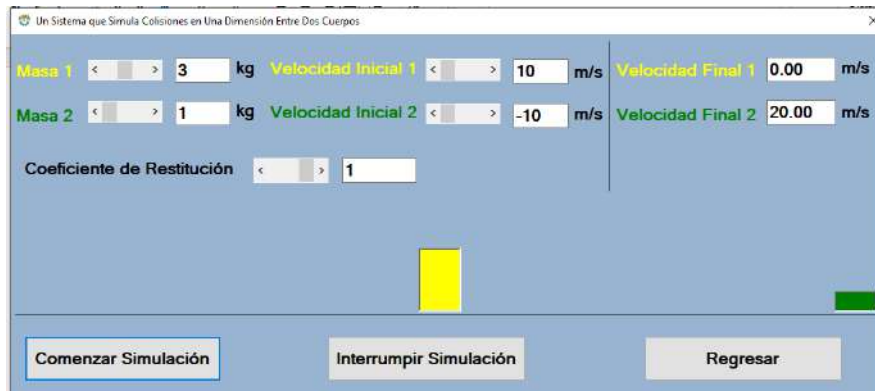
Figura 15. Ventana que muestra el resultado de la colisión cuando uno de los cuerpos tiene una masa tres veces mayor que la otra y se mueven con velocidades opuestas.
