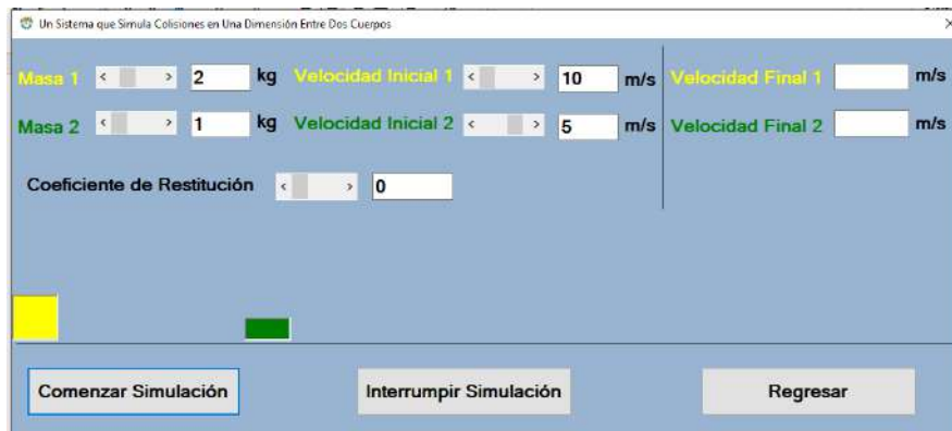
Figura 24. Ventana que muestra masas diferentes en los cuerpos, las velocidades en la misma dirección y coeficiente de restitución igual a cero.
