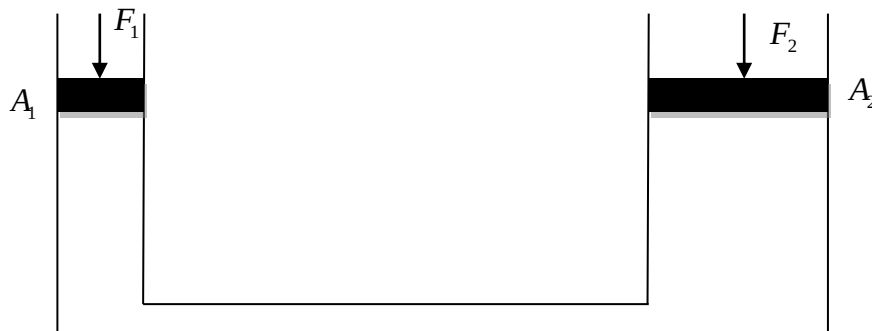
Figura 4.1 Principio de Multiplicación de Fuerzas.
