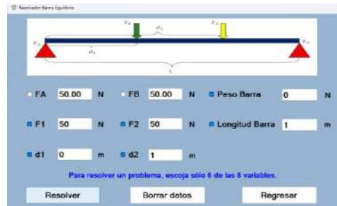
Figura 4. Ejemplo donde las fuerzas son iguales a 50 N y el peso de la barra es igual a cero.
