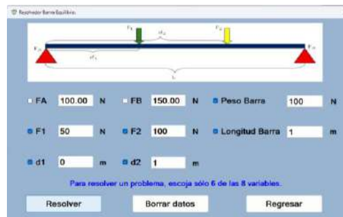
Figura 6. Ejemplo donde F_1 = 50\text{N} , F_2 = 100\text{ N} y el peso de la barra es igual a 100 N.
