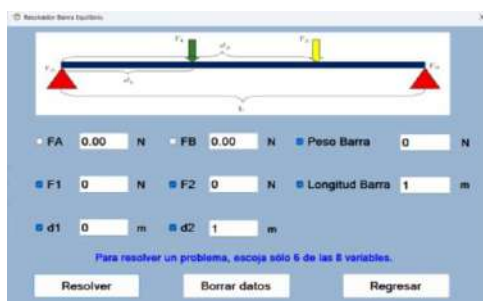
Figura 3. Ejemplo donde las fuerzas y el peso de la barra son iguales a cero.
