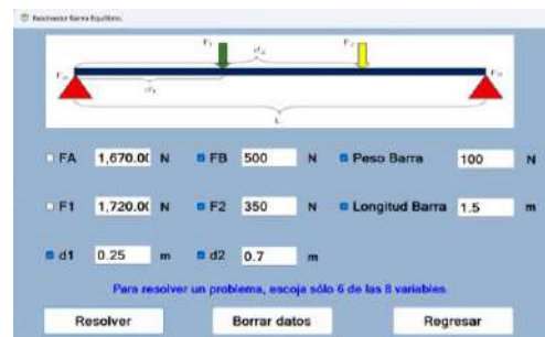
Figura 13. Ejemplo donde F_B = 500\text{ N} , F_2 = 350\text{ N} , d_1 = 0.25\text{ m} , d_2 = 0.7\text{ m} , P = 100\text{ N} y L = 1.5\text{ m}
